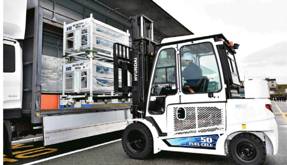
수소모빌리티 실증사업이 진행되는 현대글로벌서비스 울산 KD 센터에서 작업자가 수소지게차를 이용해 작업을 하고 있다. 현대모비스 제품
